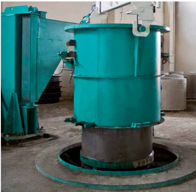
Formeneinrichtung: Formkern und Formmantel mit Zubehör sowie eine für die Handhabung nützliche Traverse. Vibrationssystem mit in den Formkern eingebauten Zentralvibratoren, optional mit Frequenzumformer.
